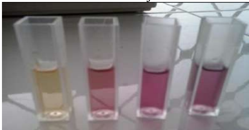
Gambar 1. Larutan Seri Vitamin C Konsentrasi 0,4 ppm, 0,2ppm, 0,18 ppm, 0,12 ppm (Dibaca dari kiri ke kanan)
